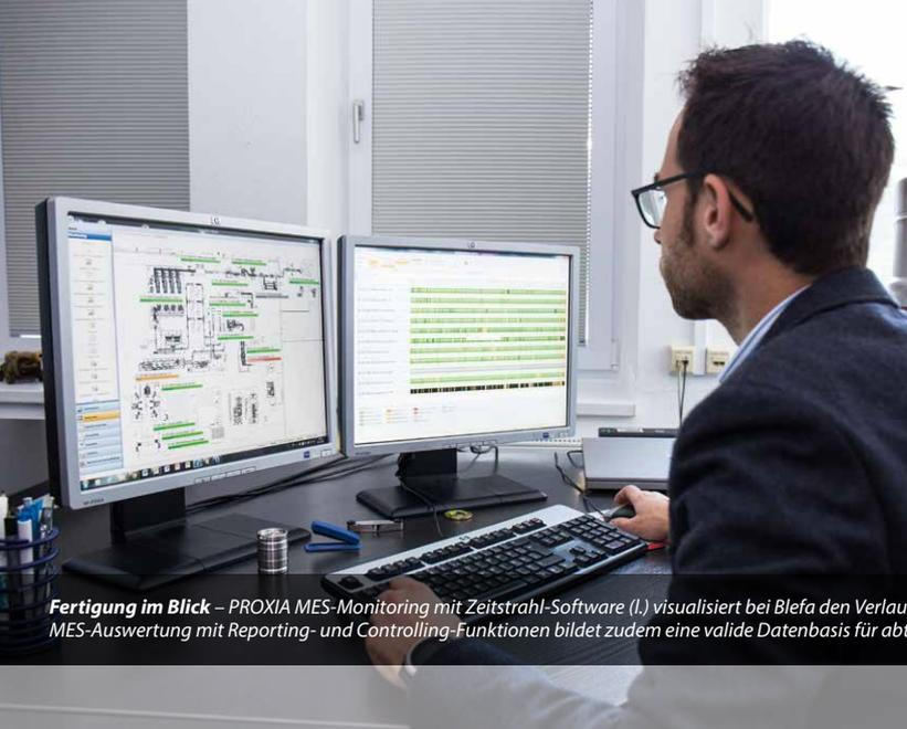
**Fertigung im Blick** – PROXIA MES-Monitoring mit Zeitstrahl-Software (l.) visualisiert bei Blefa den Verlauf und Status der kompletten Keg-Fass Produktion (r.) in Echtzeit. MES-Auswertung mit Reporting- und Controlling-Funktionen bildet zudem eine valide Datenbasis für abteilungsübergreifende, aussagekräftige Kennzahlen zur Optimierung in Regelkreisen.
