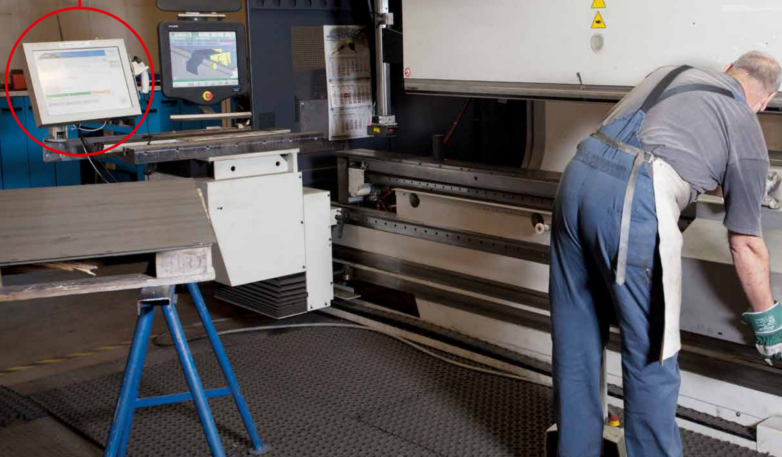
Die neue praxisorientierte BDE-Software ersetzt den alten Laufzettel-Workflow und sichert eine hohe Datenqualität sowie schnelle Bemeldungen von Betriebs- und Maschinendaten (z.B. Produktion, Stückzahlen, Stillstände, Wartung) in Echtzeit.
