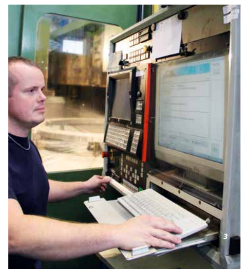
3 | Anwenderfreundlich: Die einfache Bedienung des BDE-Systems ermöglicht auf einen Klick den Soll-Ist-Vergleich mit den Vorgabezeiten.
