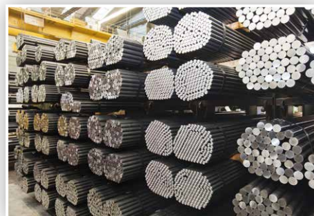
Vorher-Nachher – Aus Stahl-Drahtrollen (sogenannte Coils) verarbeitet Steeltec in hochkomplexen Fertigungsschritten Blankstahl-Stäbe verschiedenster Güte, Legierungen, Durchmesser und Längen. Stähle des Unternehmens kommen weltweit in Branchen wie z.B. der Automobilindustrie, dem Maschinenbau oder Hydraulikanwendungen zum Einsatz.
